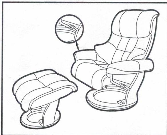
bitte immer an beiden Seiten gleichzeitig verstellen, um eine sichere Funktion zu gewährleisten
