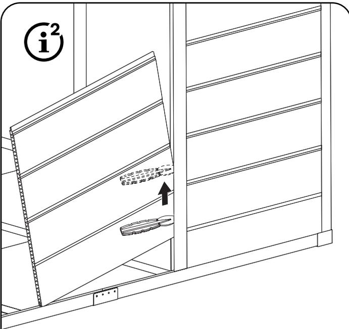
Benutze den Spachtel **SG8**, um die Panele leichter in die Nut der Profile einführen zu können.
