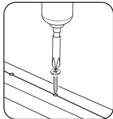
Wir empfehlen, die Löcher 2 mm tief vorzubohren, um das Einschrauben der Schrauben zu erleichtern und das Material zu schonen.
