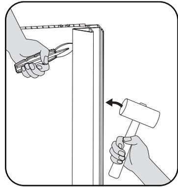
Benutze den Spachtel **SG8** und einen **Gummihammer**, um die Profile leichter mit den Panelen verbinden zu können.
