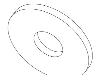
$\varnothing 4 \times \varnothing 12 \times 1 \text{ mm}$
