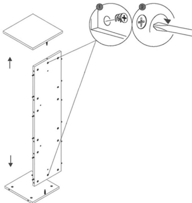
**Schritt 4: Verbindungsbeschlag eindrehen, Seitenwände befestigen**
