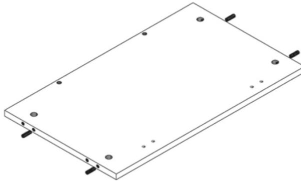
**Schritt 3: Verbindungsbeschlag eindrehen, Rückwand befestigen**
