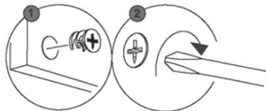
**Schritt 4: Verbindungsbeschlag eindrehen, Unterschrank zusammensetzen**
