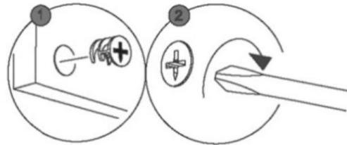
**Schritt 5: Winkel anschrauben, „Push to open“ montieren**
