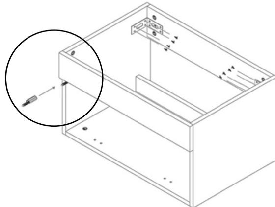
**Schritt 6: Scharnier in der Frontklappe montieren und einstellen**
