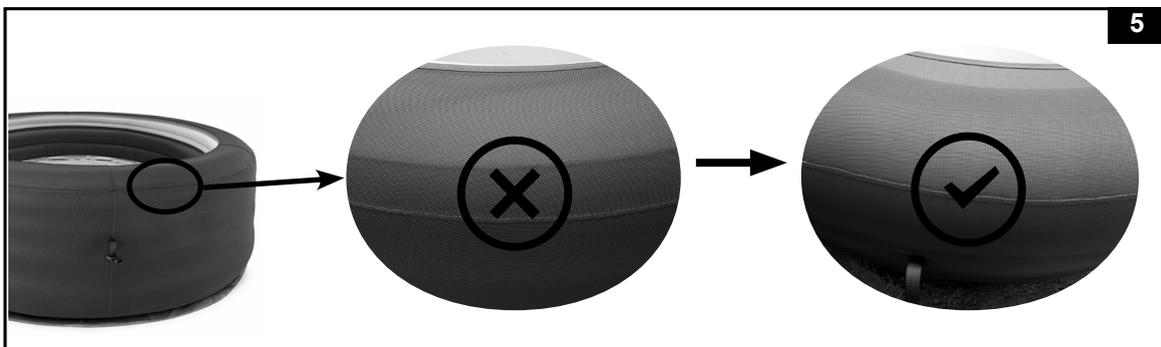
7. Bringen Sie die Kappe des Luftventils wieder an. Diese Kappe ist dafür gedacht, um an- und abgeschraubt zu werden. Üben Sie dabei niemals Kraft aus, da sonst das gesamte innere Aufblas-System des Ventils sich lockern könnte. Informationen über die Wartung des Luftventils finden Sie unter "Befestigung des Luftventils des Whirlpools".
