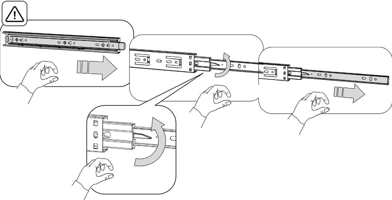
**Hinweis:** Ziehen Sie den schmalen Teil der Schubladenschiene in die gezeigte Richtung bis zum Ende aus. Betätigen Sie den Hebel in die angegebene Richtung, während Sie gleichzeitig die Schienen voneinander trennen.
