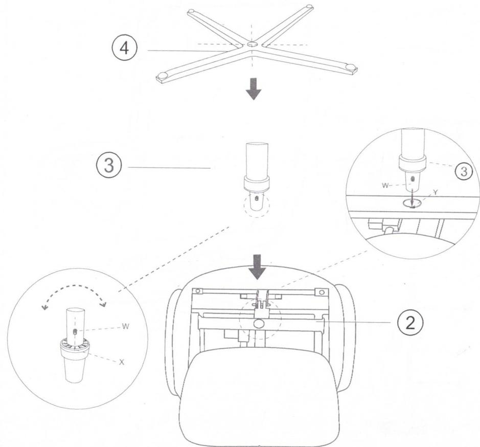
Stellen Sie sicher, dass der Bolzen (W) mit der Nut (X) auf der Spindel (3) ausgerichtet ist.
