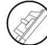
Platzieren Sie den Stecker (P9), so dass die Vorderseite des Steckers mit der Schreibtischplatte passt. Sie können diesen überall montieren, beachten Sie jedoch, dass der Stecker Sie nicht beim Sitzen beeinträchtigen soll. Wir empfehlen daher, diesen an die Enden recht oder links zu montieren. Nutzen Sie dazu 2 M5\*16 Schrauben für Holz (P17)
