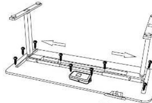
Je nach Modell, montieren Sie nun das 3. Tischbein auf der Unterseite mit 4 M5\*20 Schrauben für Holz (P16).
