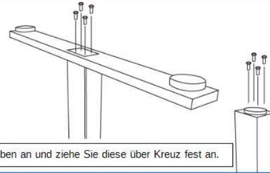
Für 1 montiertes Stück, bringen Sie den Fußstützen (P3) mit 4 M6\*14 Schrauben an und ziehe Sie diese über Kreuz fest an.
