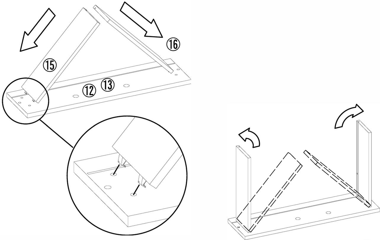
Seitenteile erst schräg ansetzen und dicht andrücken!
