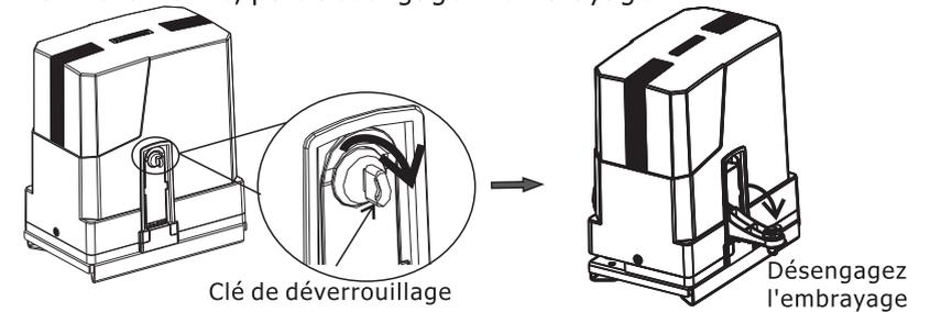
c. Fermez l'embrayage et tournez la clé de déverrouillage dans le sens des aiguilles d'une montre comme l'indique la flèche et verrouillez l'embrayage.
