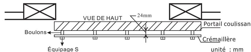
1. Souder les boulons (⑩ de P5) au portail coulissant et fixer la crémaillère aux bords Avec vis et rondelle (⑪ de P5) à travers les trous du rack.
