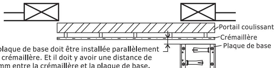
La plaque de base doit être installée parallèlement à la crémaillère. Et il doit y avoir une distance de 30 mm entre la crémaillère et la plaque de base.
