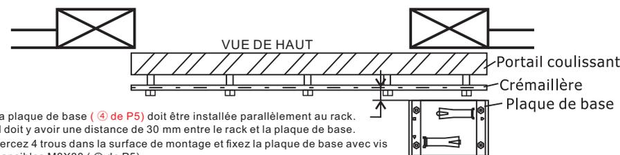
1. La plaque de base (④ de P5) doit être installée parallèlement au rack. Et il doit y avoir une distance de 30 mm entre le rack et la plaque de base.
