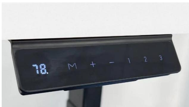
**Reset- Methode:** Drücke die „Abwärts“ Taste und der Tisch beginnt zu sinken. Schalte die Stromversorgung ab und wieder ein. Auf dem Display wird im Anschluss der Fehlercode „RST“ angezeigt. Drücke im Anschluss erneut 2 Sekunden lang auf die „Abwärts“ Taste. Wenn das Display „75“ anzeigt, ist der Reset abgeschlossen.
