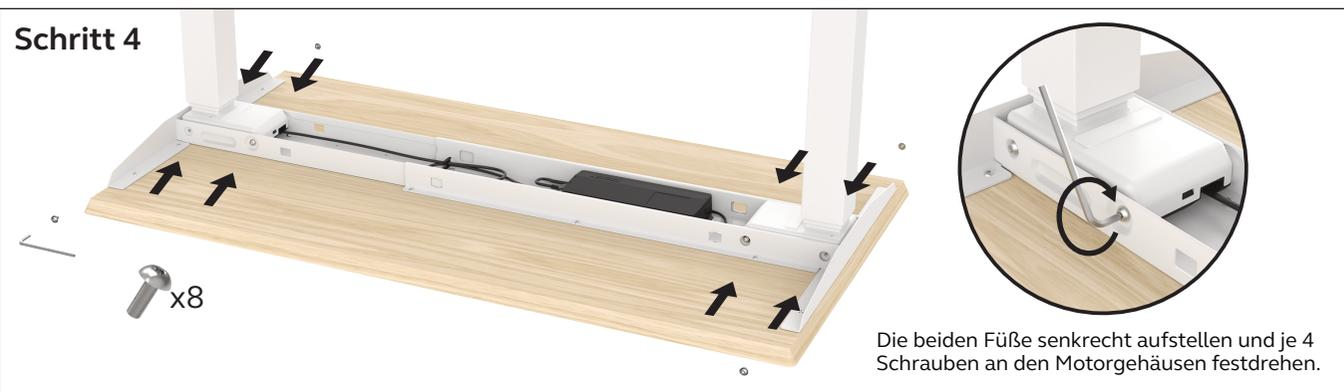
Die beiden Füße senkrecht aufstellen und je 4 Schrauben an den Motorgehäusen festdrehen.
