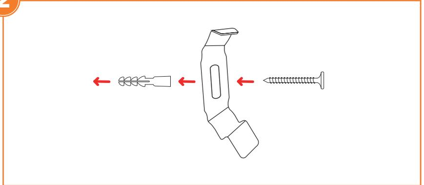
Nun werden an den entsprechenden Stellen Löcher gebohrt und die Dübel eingesetzt. Im Anschluss können die Clips für die Wand/Decke mit der Schraube befestigt werden.
