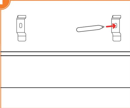
Die Positionierung der Clips für die Wand/Decke mit einem Stift kennzeichnen. Eine Wasserwaage und ein Lineal können dabei helfen die richtige Positionierung zu finden.
