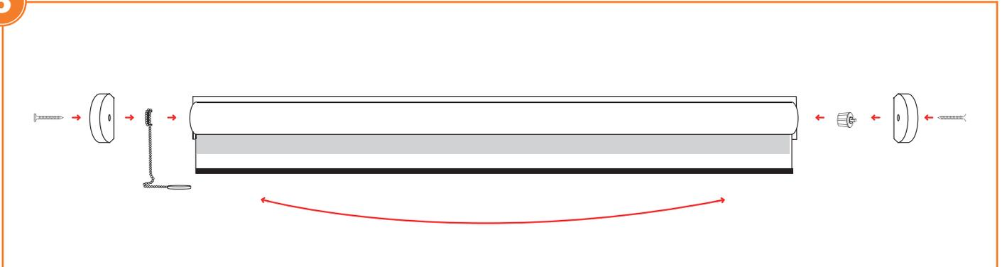
Stecken Sie den Kettenzug nun auf der linken Seite und die Plastikkappe auf der rechten Seite in das Rohr. Die Seitendeckel müssen ebenfalls getauscht werden. Abschließend setzen Sie diese ein und schrauben sie fest.
