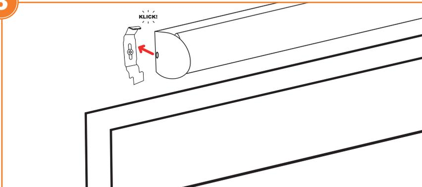
Im letzten Schritt das Doppelrollo in die Clips einhängen und etwas drücken. Ein Klicken bestätigt die Anbringung. Das Doppelrollo kann noch nach links und rechts verschoben werden, um es perfekt auszurichten.
