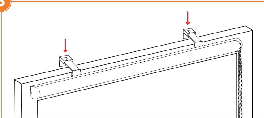
Das Fenster öffnen und das Doppelrollo mit den Klemmträgern auf den Fensterflügel hängen.
