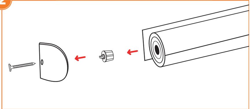
Die Schraube am linken Seitendeckel lösen und den Seitendeckel abziehen. Nun lässt sich eine kleine Plastikkappe herausziehen.
