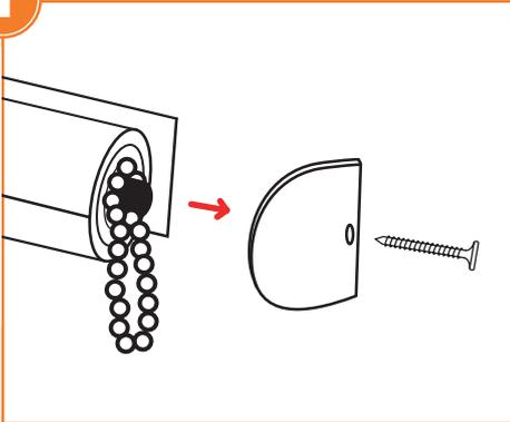
Die Schraube am rechten Seitendeckel lösen und den Seitendeckel abziehen. Nun lässt sich der Kettenzug samt Getriebe einfach herausziehen.
