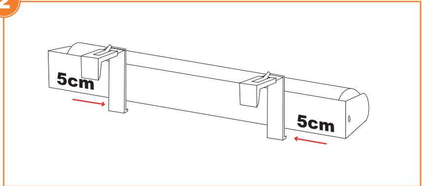
Die beiden Klemmträger hinten auf die Aluminiumschiene des Doppelrollos schieben oder vorsichtig einclippen. Der Abstand zwischen äußerer Kante der Schiene und den Klemmträgern sollte etwa 5 cm betragen.
