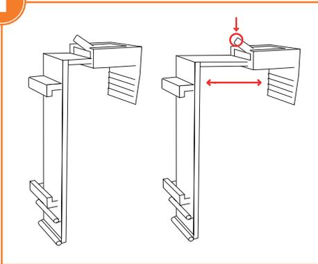
Durch das Runterdrücken der kleinen Lasche, lässt sich der Klemmträger auf die Breite des Fensterflügels aufziehen.
