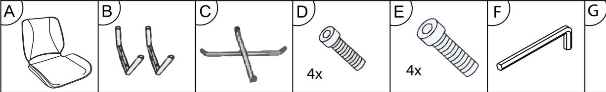
**Schritt 1:** Bereiten Sie die Montage vor, indem Sie das Verpackungsmaterial entfernen. Stellen Sie das Gestell aufrecht hin, indem Sie das Gestell gekreuzt in einander stecken.
