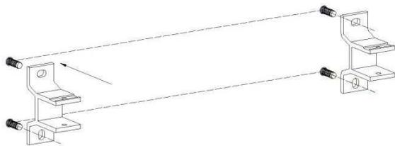
5) Ziehen Sie die Verlängerungsbolzen an und versichern Sie sich, dass die Abbringungen eng an der Wand anliegen.
