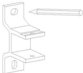
2) Bohren Sie - mit Hilfe eines elektrischen Bohrers und einem 14 mm dicken Bohrmeißels - 100 mm tiefe Löcher in eine Betonmauer in der exakten Position für die Wandanbringung.
