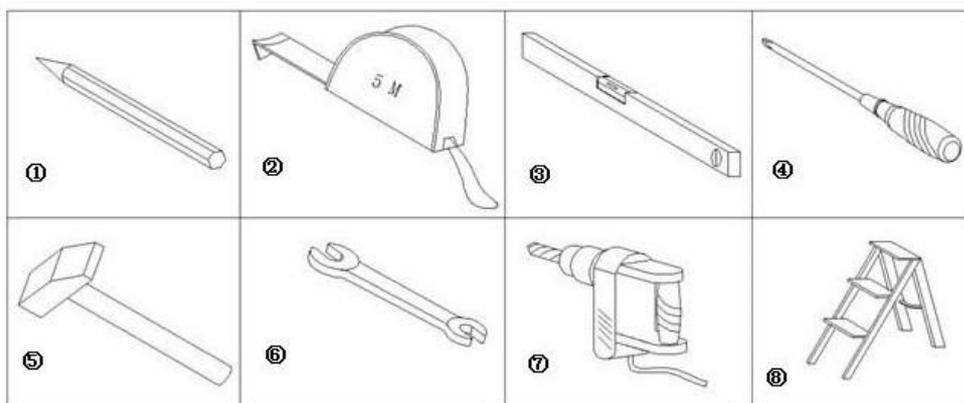
\*Hinweis: 1 Bleistift 2 Maßband 3 Waage 4 Schraubenzieher 5 Hammer 6 17/19 mm Schraubenschlüssel 7 elektrischer Bohrer (14 mm Bohrmeißel) 8 Leiter
