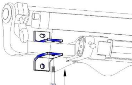
8) Befestigen Sie die Mutter auf dem Bolzen und ziehen Sie diese fest.
