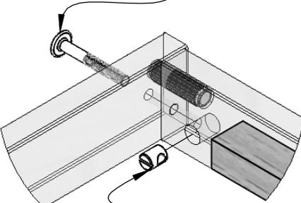
1) Insérer la pièce n°8 de façon à avoir l'axe du filetage en direction de la vis
