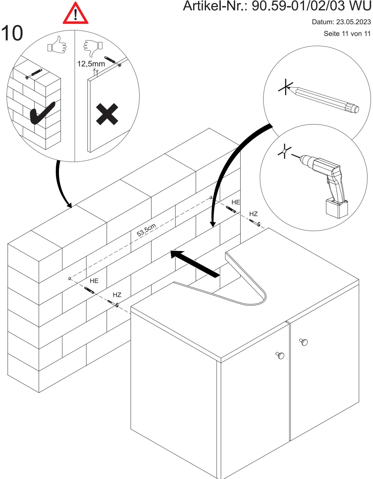
Für die Wandmontage von Schränken werden evtl. auch Schrauben und Dübel beige packt. Das Set eignet sich für die Montage an homogenen Wänden. Bei Hohlblock, Gipskarton etc. besorgen Sie sich bitte im Baumarkt dafür geeignetes Material.
