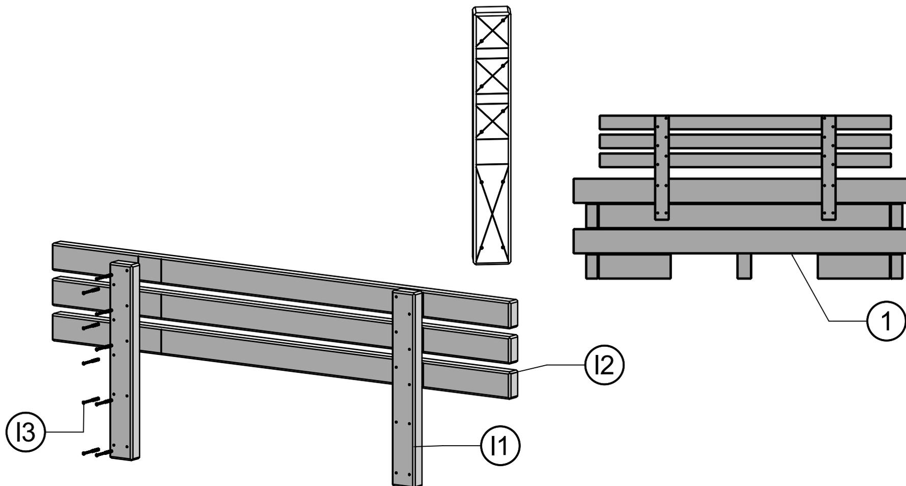
Legen Sie die Lamellen (Pos. 12) mit der angezeigten Seite nach oben auf den Boden aus.
