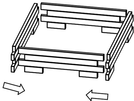
1. Verbinden sie Längs- (Pos. 2) und Querteile (Pos. 1).
