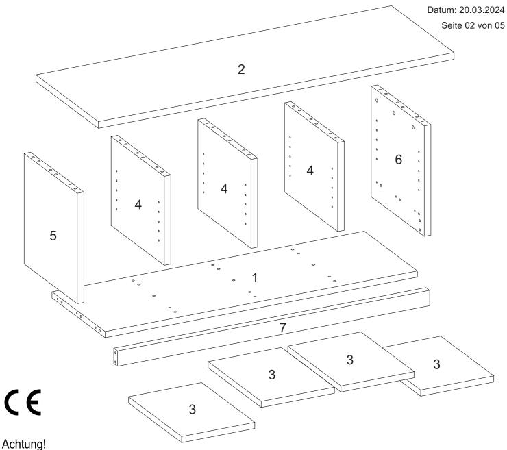
Bevor Sie die Schrauben, Dübel, Muttern in die dafür vorgesehenen Löcher stecken, prüfen Sie, ob sich gegebenenfalls noch Holzspäne in den Löchern befinden.
