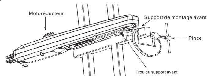
(5) Maintenez le moteur soulevé et tirez-le pour ouvrir le portail jusqu'à ce que le trou dans le support rencontre le trou du moteur. Fixez le moteur au support arrière à l'aide des goupilles fendues (⑩ de P3) puis insérez la goupille de blocage (⑪ de P3) dans la goupille fendue. (Fig.8)
