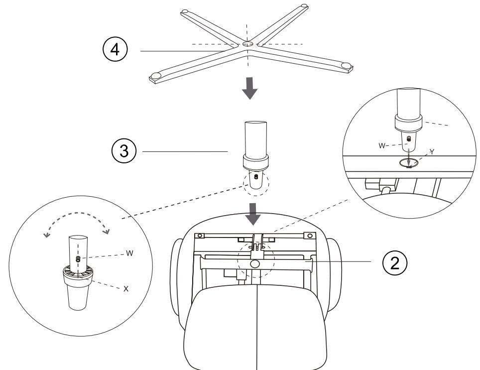
Stellen Sie sicher, dass der Bolzen (W) mit der Nut (X) auf der Spindel (3) ausgerichtet ist.
