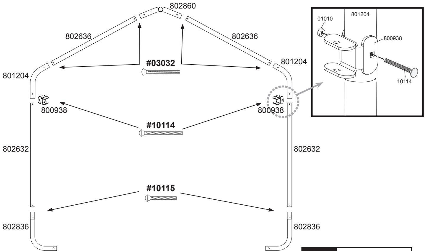
**WICHTIG:** Die Schraubenköpfe müssen nach außen zeigen, um Schäden an der Abdeckung zu vermeiden.
