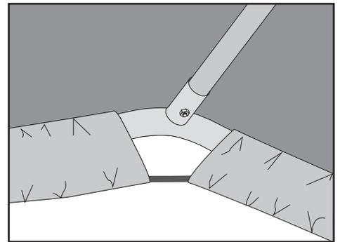
C. (C1) Lösen Sie die seitliche Querstange vom ShelterLock® 3X. (C2) Ziehen Sie das Gurtband (das schwarze Band) nach Innen über die Verbindung. (C3) Verbinden Sie die seitliche Querstange wieder mit dem ShelterLock® 3X und schrauben Sie diese fest. Wiederholen Sie den Schritt an der gegenüberliegenden Seite.
