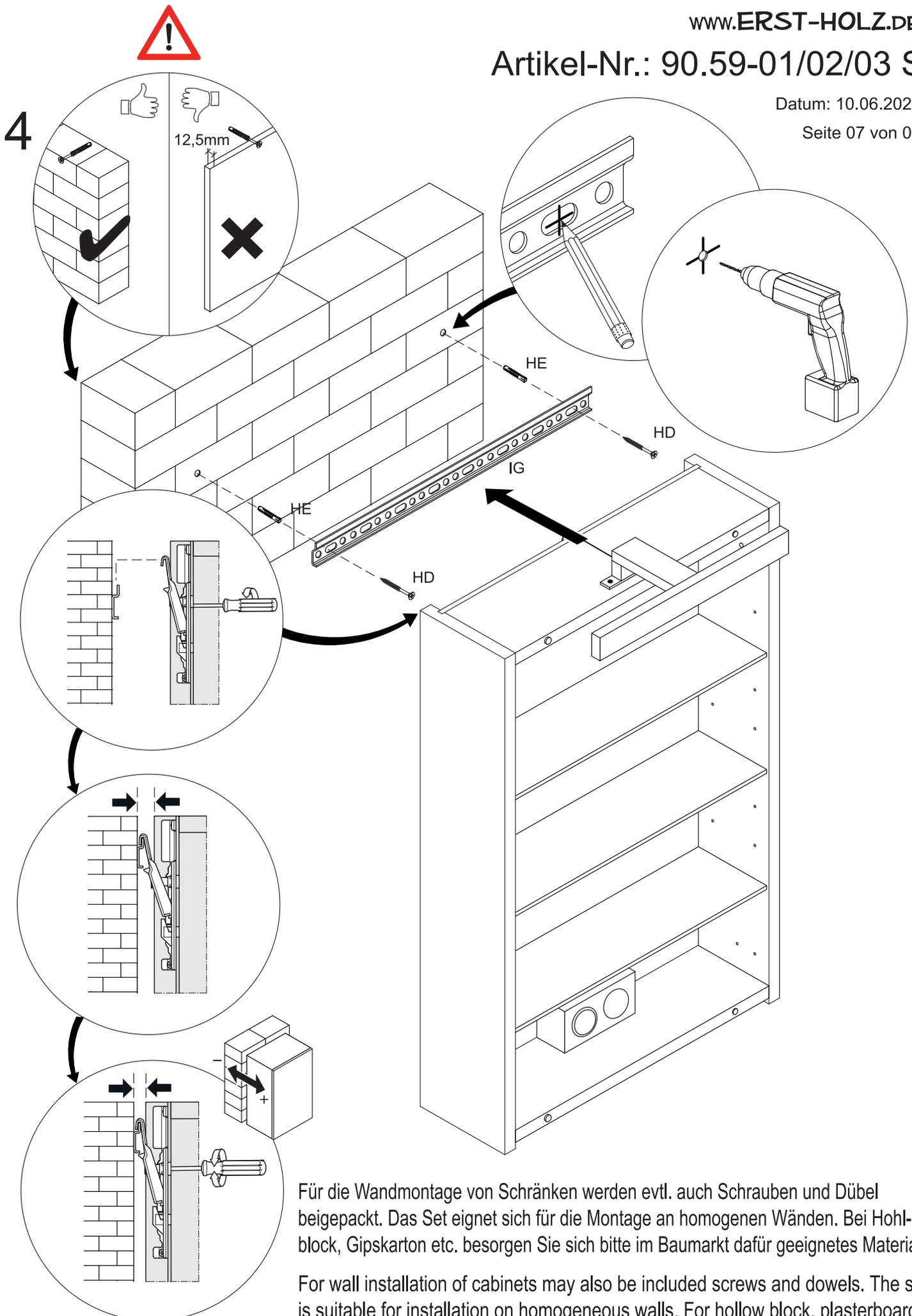
Für die Wandmontage von Schränken werden evtl. auch Schrauben und Dübel beige packt. Das Set eignet sich für die Montage an homogenen Wänden. Bei Hohlblock, Gipskarton etc. besorgen Sie sich bitte im Baumarkt dafür geeignetes Material.
